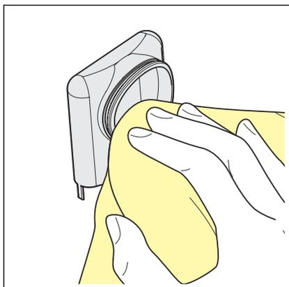
► Den Geruchverschluss für den seitlichen Zulauf reinigen.
