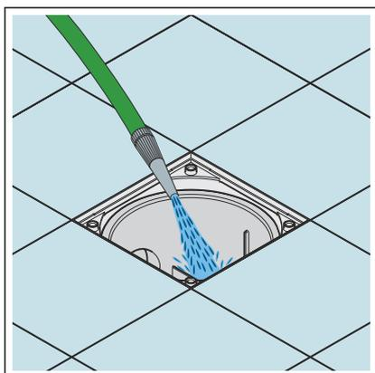
► Das Gehäuse reinigen.
