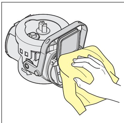
► Die Rückstaeinheit reinigen.
