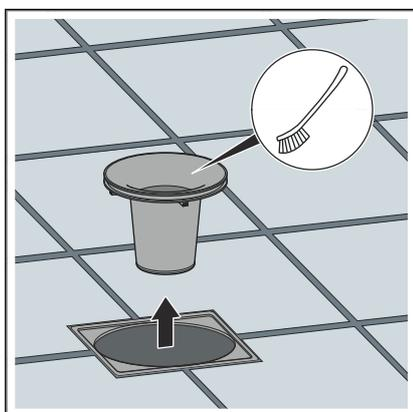
► Das Tauchrohr entnehmen und reinigen.
