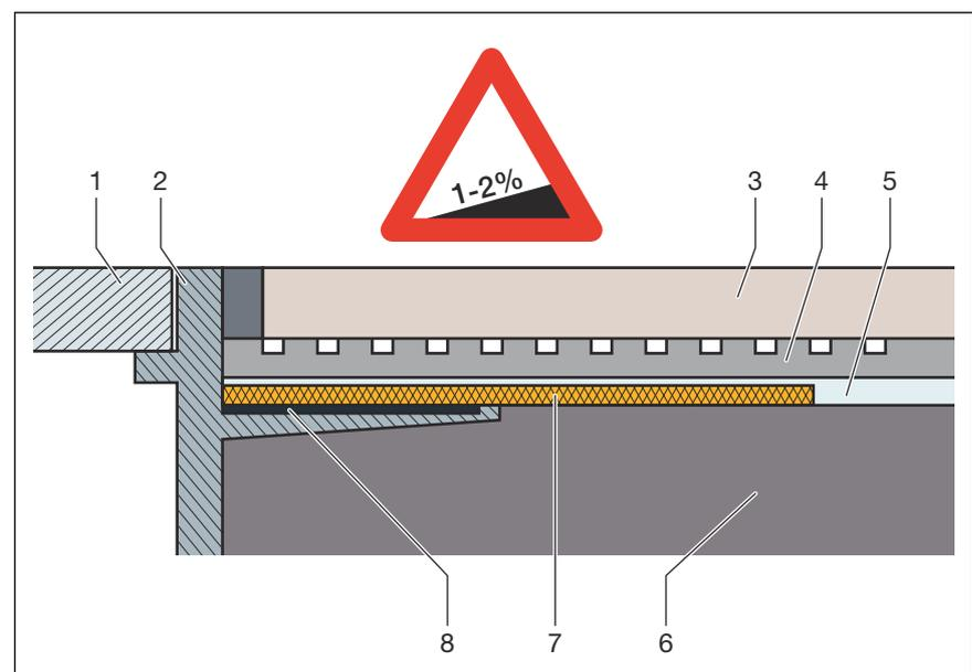
**Abb. 4: Aufbauschema der Verbundabdichtung – Estrichgefälle min. 1–2 %**
