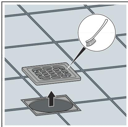
► Den Rost entnehmen und reinigen.
