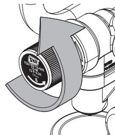
Die Sicherheitsgruppe 324 ist mit einem **Druckminderer** ausgestattet. Der Druckminderer ist werkseitig auf 4 bar Ausgangsdruck eingestellt. Andere Einstellungen können zwischen 1,5 und 6 bar vorgenommen werden.
