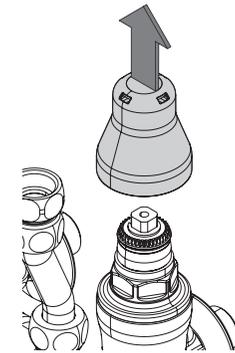
Durch Drehen des Messing-Vierkants (SW10) wird der Ausgangsdruck verstell.
