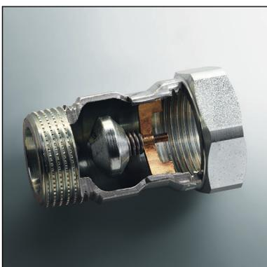
Der Dichtkegel ist mit einer Feder vorgespannt und wird durch ein Schmelzlot in seiner Position gehalten. Das Lot schmilzt bei einer Temperatur von  $> 96^{\circ}\text{C}$ . Die Feder entspannt sich und drückt den Ventilkegel in die Durchflussöffnung. Der Gasfluss ist damit abgesperrt und das Ventil ist nun dauerhaft gasdicht verschlossen.
