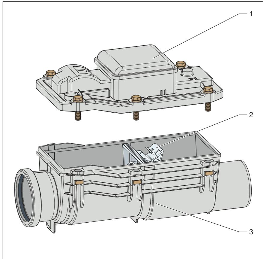
**Abb. 3: Rückstauverschluss Grundfix Typ 0**
